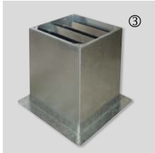
JAA Akoestische dakopstand - Vermindert verspreid geluid in luchtkanaal. - Voor montage van een ventilator op een platdak zonder opstanden. - Geleverd met schroeven en pakking voor een volledig weersbestendige afdichting.
