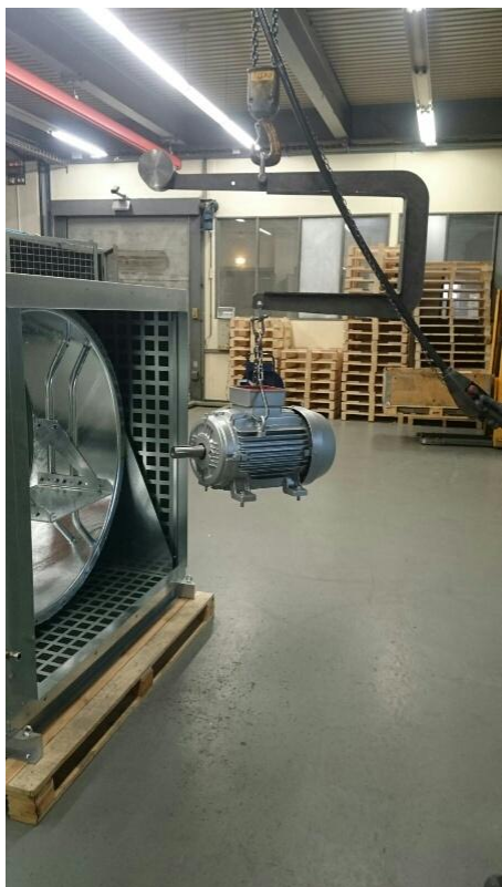
Рис. 21 Типовая конструкция подъемника для электродвигателя осевых вентиляторов
